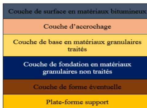
Figure 4 : Structure type d'une chaussée semi-rigide
