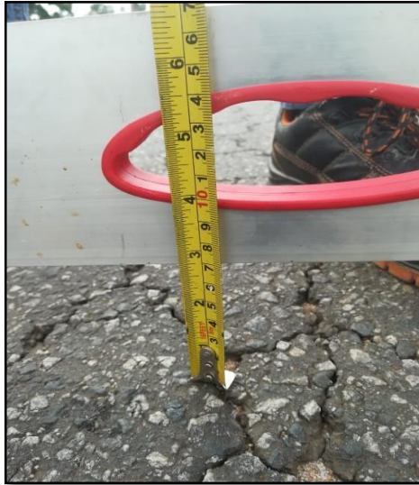
Figure 28 : Photo de la mesure d'uni à la règle de 3 m
