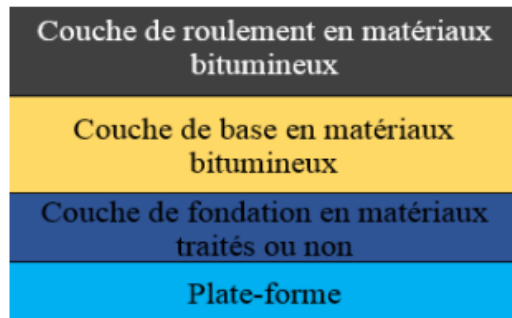
Figure 3 : Structure type d'une chaussée bitumineuse épaisse
