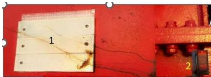
FIGURE 2.12 – Capteur de détection monté avec son réflectant 1 : Plaque réflectant, 2 : Capteur de détection
