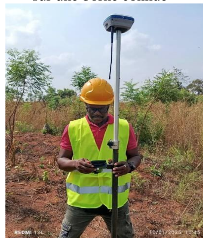
Photo 6: Calade du récepteur sur une borne connue
