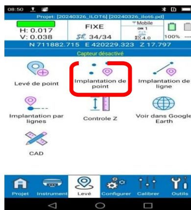
Image 1: Procédure N°2 d'implantation avec GPS Source : Y. N. Michel
