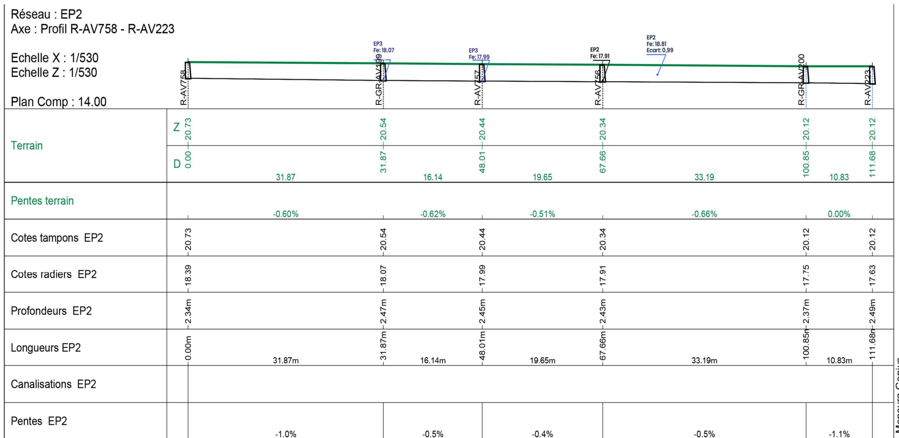
Figure N°36 : Profil en long présentant la résolution du conflit du réseau eaux pluviales à l'intersection des rues N°12 et 35
