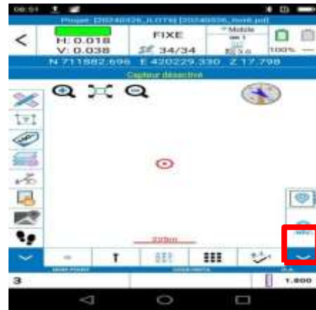
Image 4 : Procédure N°2 d'implantation avec GPS
