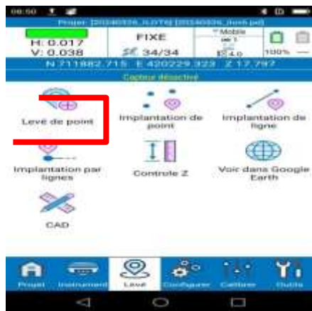
Image 3 : Procédure N°1 d'implantation avec GPS
