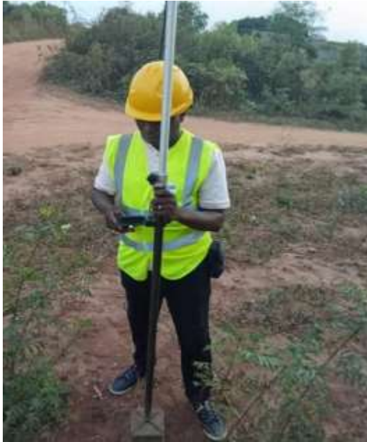
Photo 5: Calage du récepteur sur une borne connue
