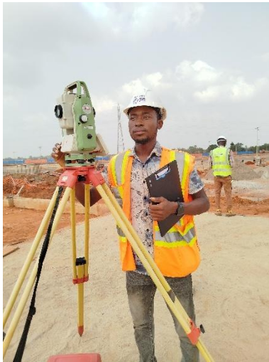
Photo 16: Implantation avec la Station Totale
