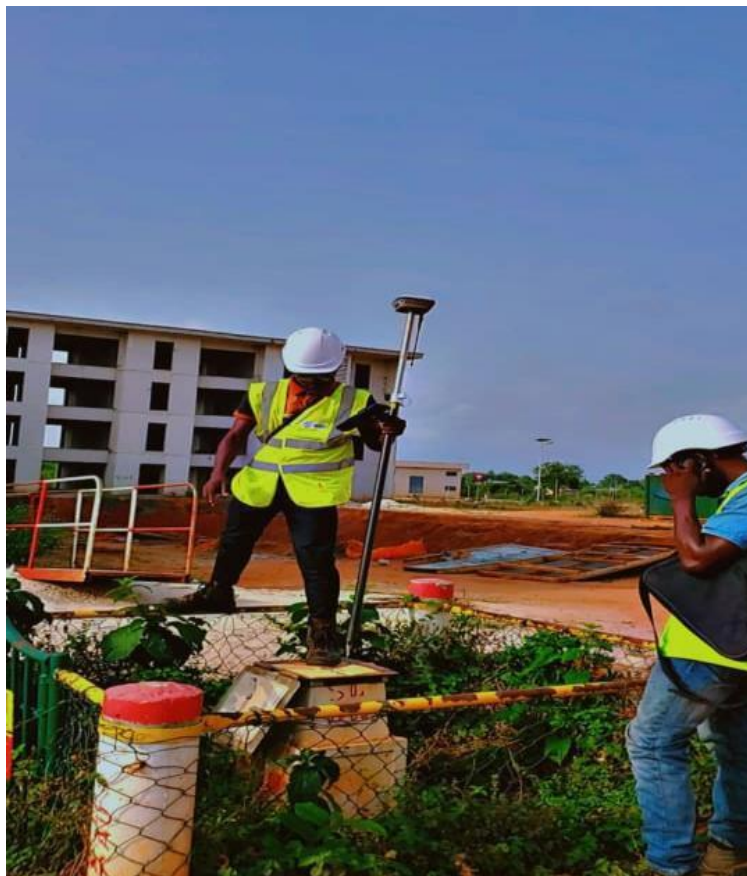
Photo 9: Calage du récepteur sur une borne connue
