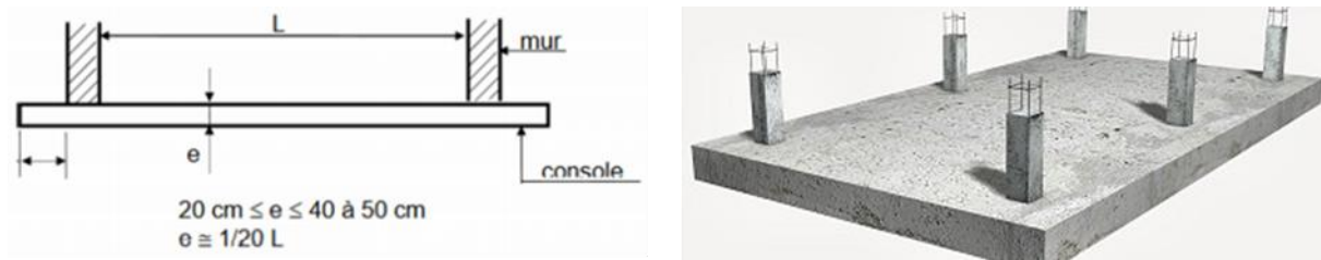
Figure 8 : Radier plat d'épaisseur constante [6]
