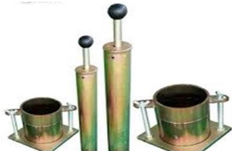
Photo 11 : Moule et dame Proctor normal et modifiée
