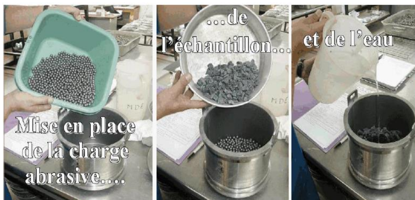
Photo 18 : mode opératoire de l'essai micro deval
