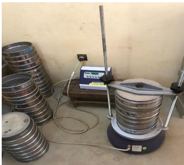
Figure 10 : série des tamis normalisés avec l'appareil vibratoire
