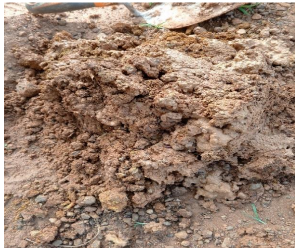
Photo 3 : Sondage à la tarière manuelle avec récupération de matériaux
