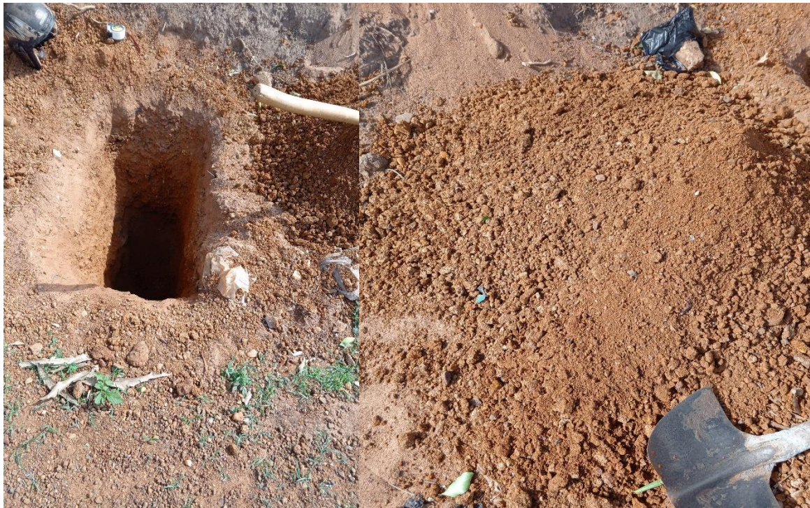
Photo 10 : Prélèvement de matériaux pour les essais d'identification
