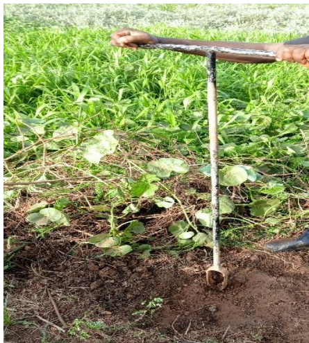
Photo 3 : Sondage à la tarière manuelle avec récupération de matériaux
