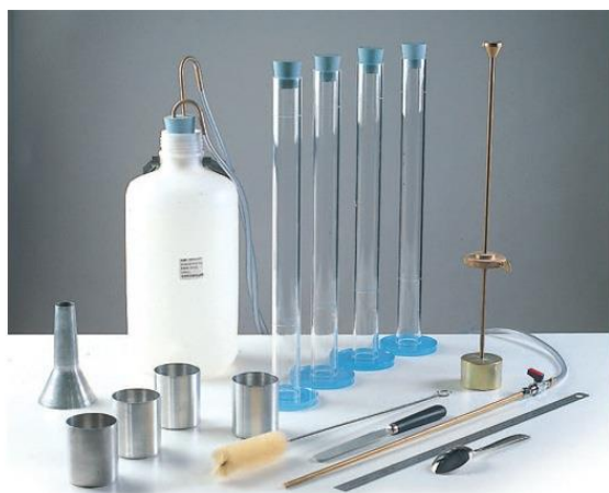
Photo 16 : Matériels pour réalisation de l'équivalent de sable
