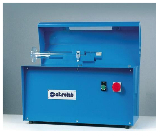
Photo 16 : Matériels pour réalisation de l'équivalent de sable
