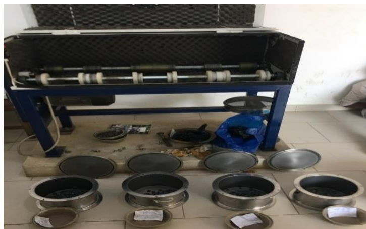
Photo 19 : Appareil de micro deval, jarre et échantillon
