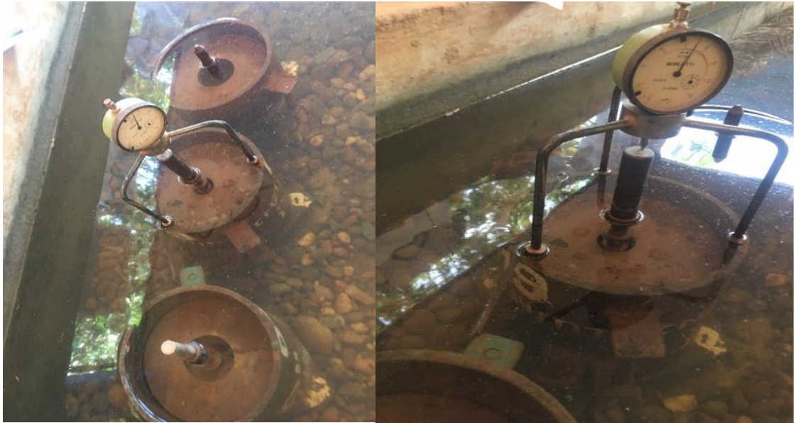
Photo 13 : Immersion des moules CBR
