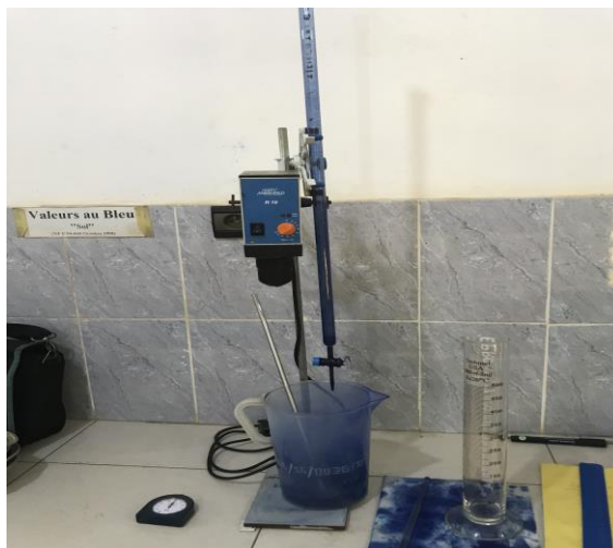
Photo 8 : Appareillage pour l'essai de VBS
