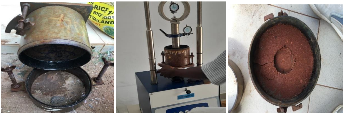
Photo 14 : Les étapes de poinçonnement
