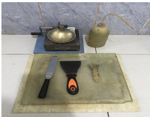
Photo 6 : Appareillage pour l'essai de limite d'ATTEMBERG
