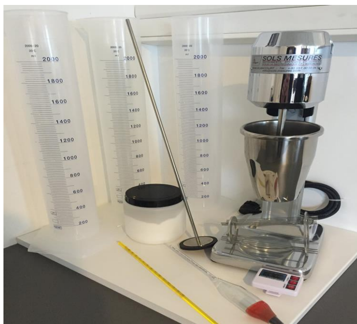
Photo 4 : Appareillages pour réalisation de l'analyse granulométrique par sédimentométrie
