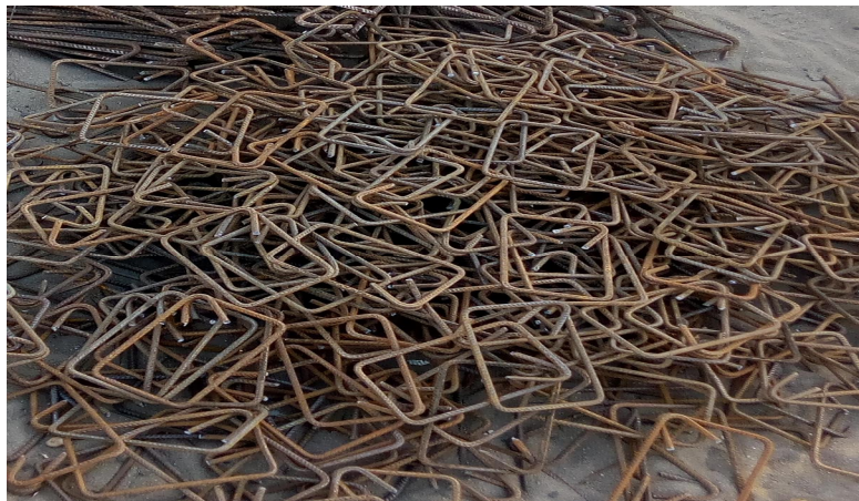
Photo 7 : Aciers façonnés (source : MESSOUNA S.)
