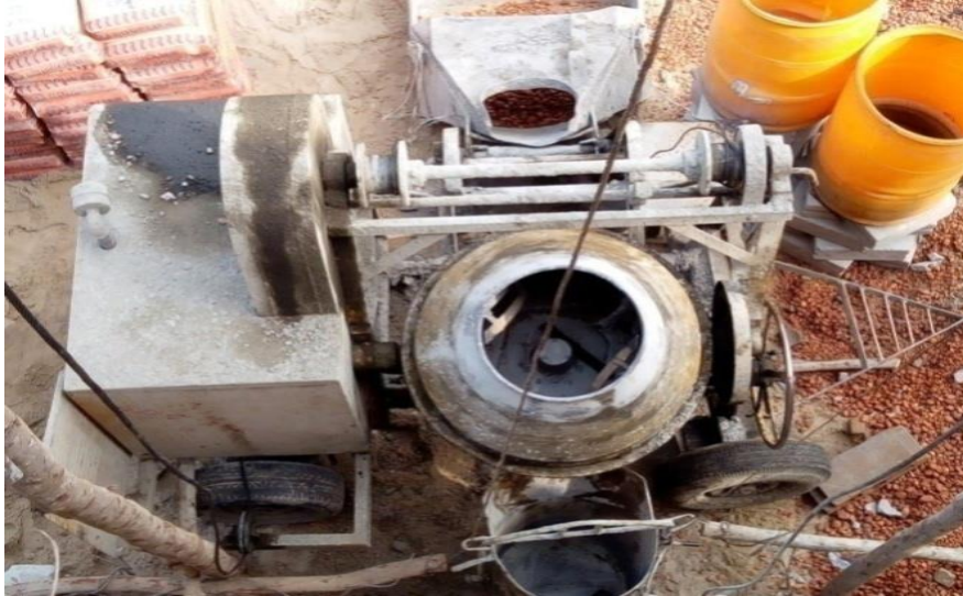
Photo 3 : Bétonnière (source : MESSOUNA S.)
