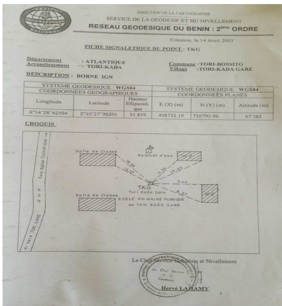
Figure N°23 : Fiche signalétique de la borne IGN-TKG Source : IGN, Avril 2003
