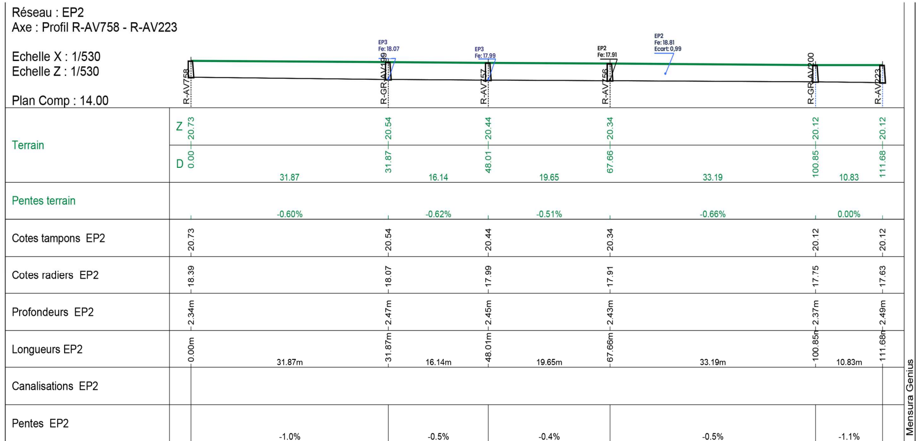
Figure N°36 : Profil en long présentant la résolution du conflit du réseau eaux pluviales à l'intersection des rues N°12 et 35
