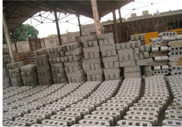
**Photos n°7 : Entrevous sur l'aire de préfabrication et de stockage**
