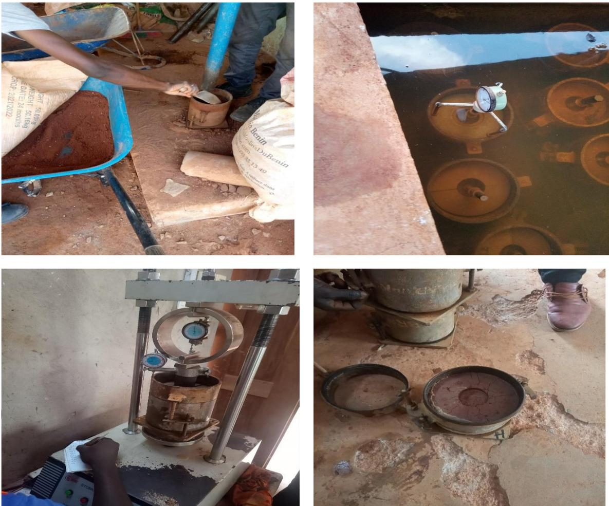
Photo 3.8 : Essai CBR sur les divers mélanges.
