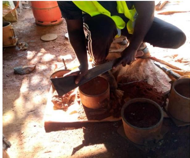
*Photo 3.2 : Compactage Eprouvettes CBR*
