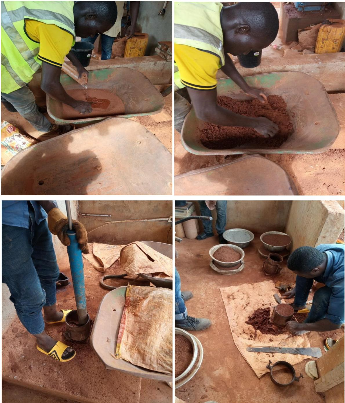
***Photo 3.6 : Proctor : Mouillage du matériau-Malaxage-Compactage & Arasement.***
