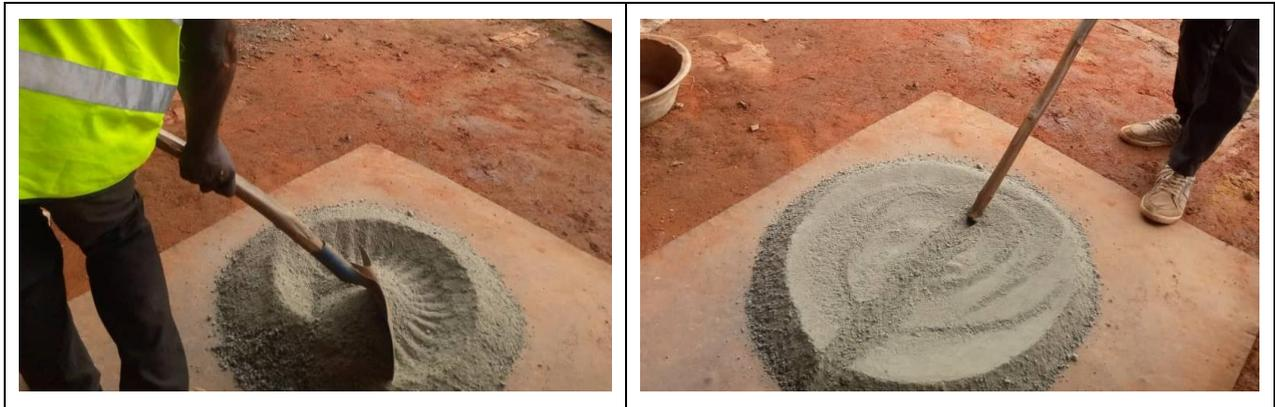
*Photo 3.3 : Séchage du Sable Concassé 0/5 et préparation des échantillons pour Essai.*
