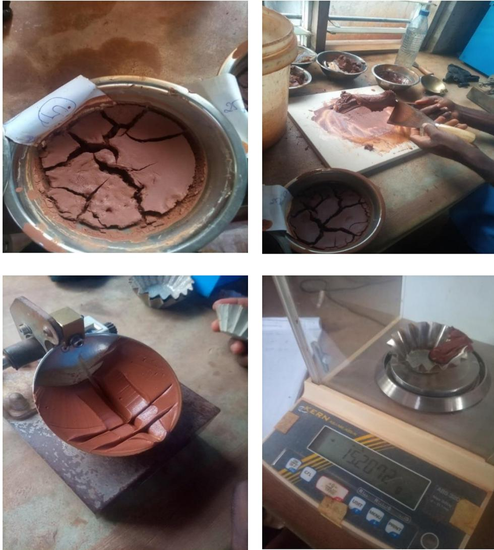
*Photo 3.7 : Essai de Limites d'Atterberg sur les divers mélanges.*
