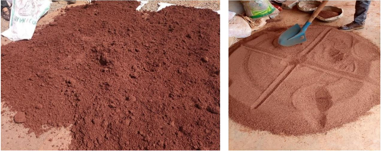
Photo 3.1 : Séchage de la Terre de barre et préparation des échantillons pour Essai.
