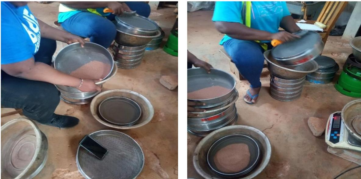
**Photo 3.4** : Analyse granulométrique des mélanges Terre de Barre et Sable Concassé.
