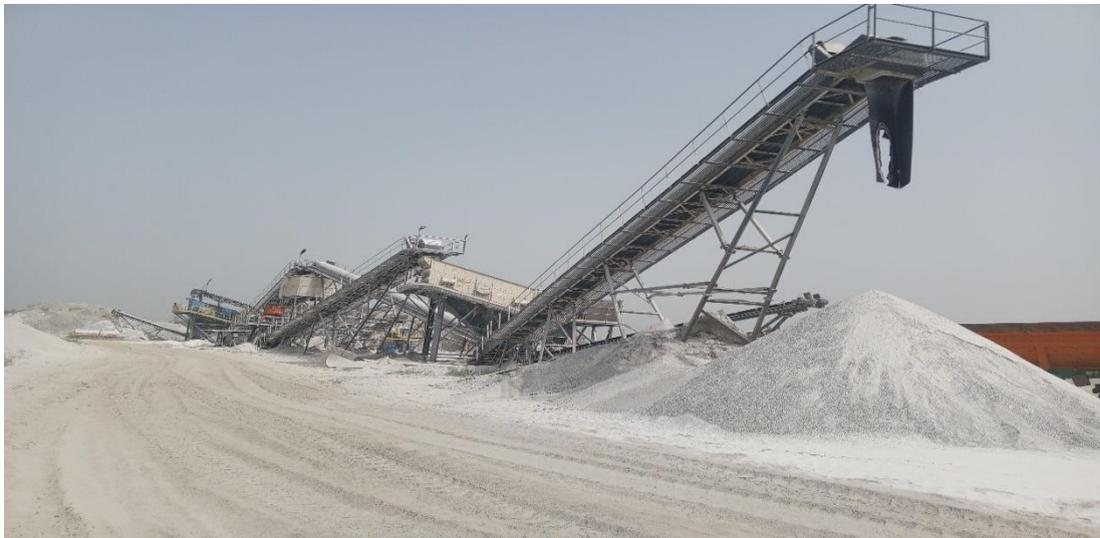
***Photo 1.1 : Image montrant le concasseur, la trémie et le sable concassé 0/5
