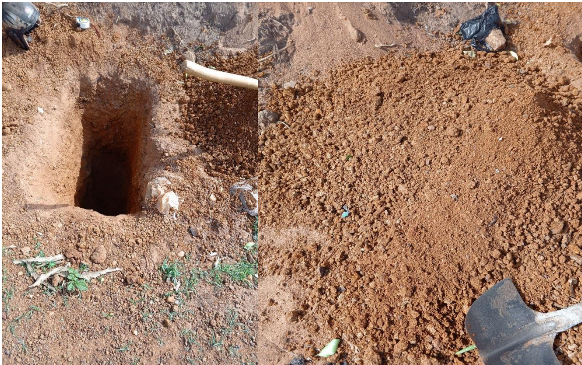
Photo 5 : Prélèvement de matériaux pour les essais d'identification
