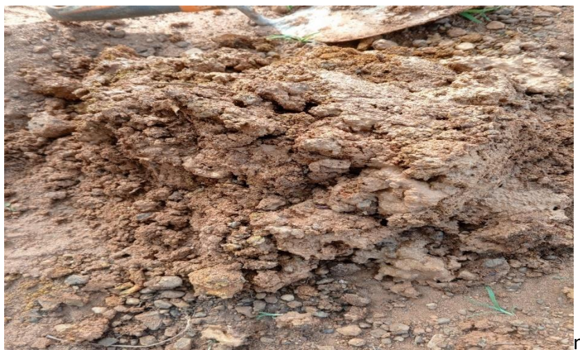
Photo 4 : Echantillon récupéré lors de l'essai à la tarière
