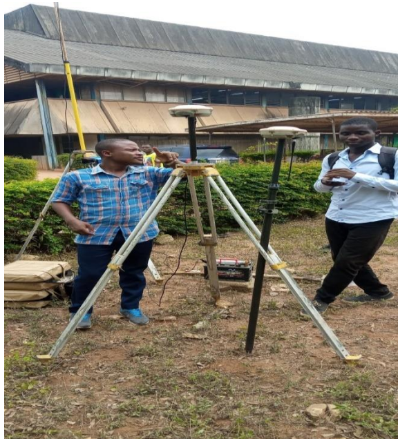
Photo N°9 : Vue montrant l'installation de la base
