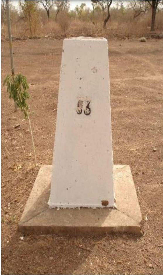
Photos N°1 & 2 : Vue montrant deux bornes géodésiques dont celle à gauche du 1 er ordre et celle à droite de 2eme Ordre
