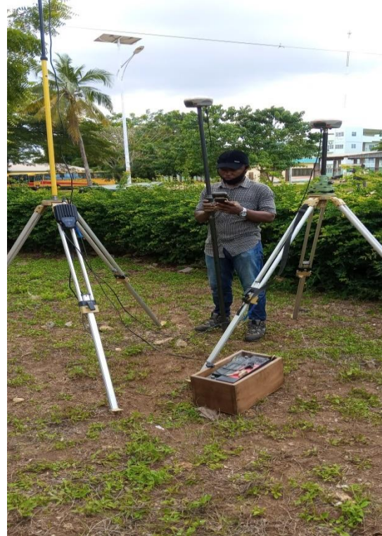
Photos N° 3 & 4 : Vue montrant l'installation de la base et l'antenne (radio) de T30 Sino GNSS.
