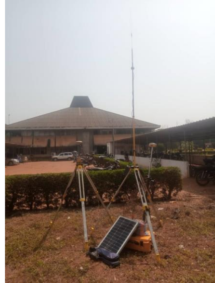
Photos N°5 & 6 : Vue montrant base fixe ainsi que l'antenne
