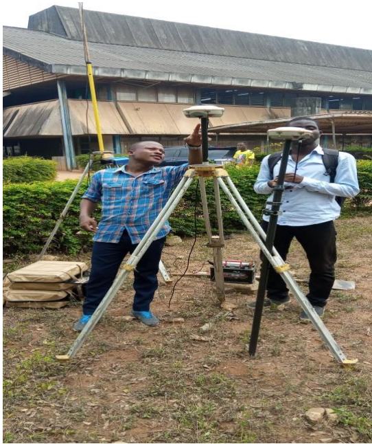
Photos N°24 & 25 : Le rattachement et la prise en compte des points dans le système
