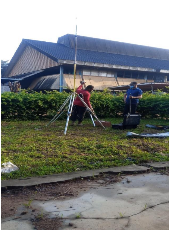
Photos N° 3 & 4 : Vue montrant l'installation de la base et l'antenne (radio) de T30 Sino GNSS.
