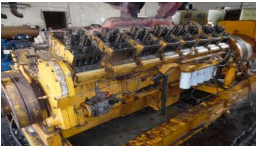
Figure 17: Groupe électrogène 2250 kVA dépouillé, nettoyé, enchemisé et en cours de remontage
