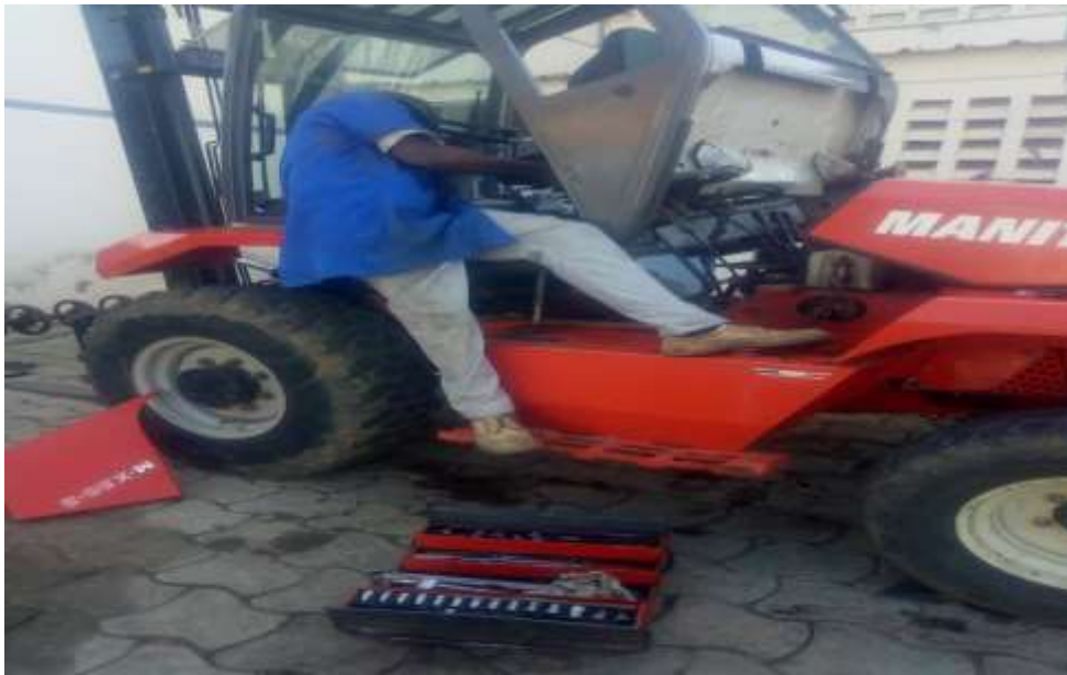
Figure 20 : Remise en état de la valve de commande électrique pour le levier d'inverseur du MANITOU M-X30-2
