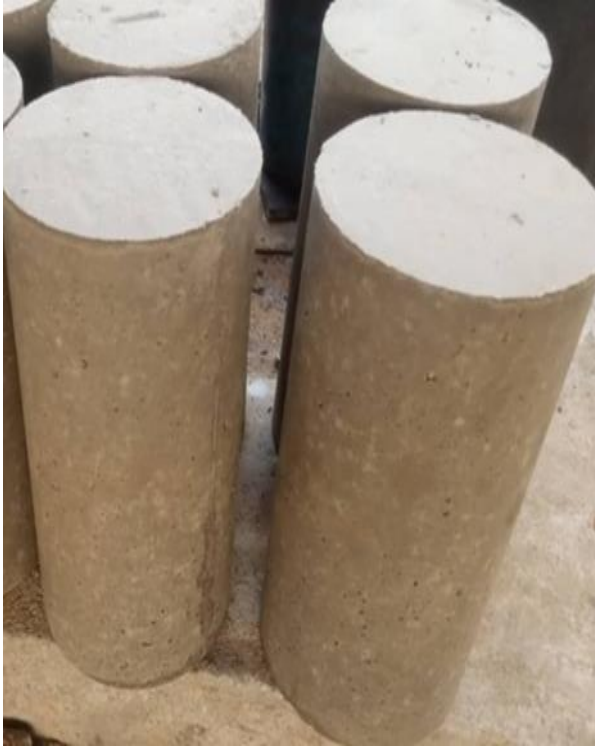
Eprouvettes béton de latérite lavée durci avant écrasement
