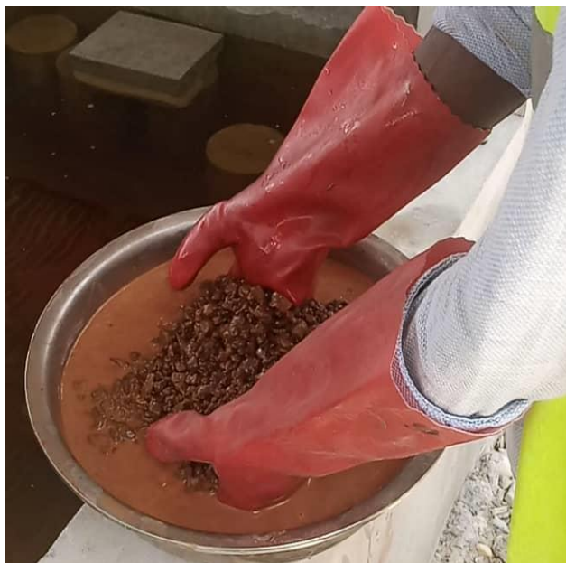
Lavage des granulats de tailles 4/25
