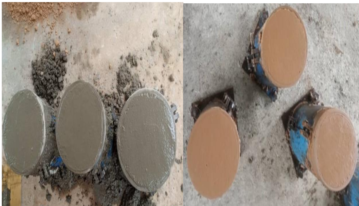
Béton de latérite lavée
