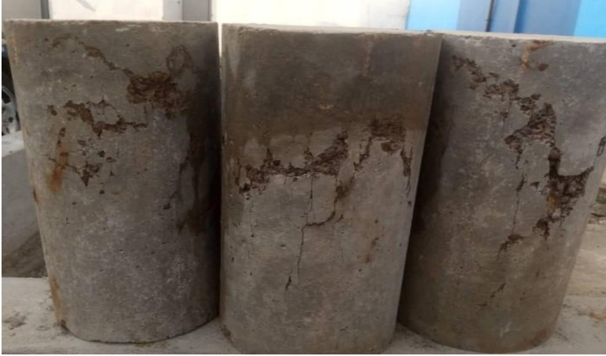
Eprouvettes de béton de latérite lavée dose 350\text{kg/m}^3 après essai de compression
