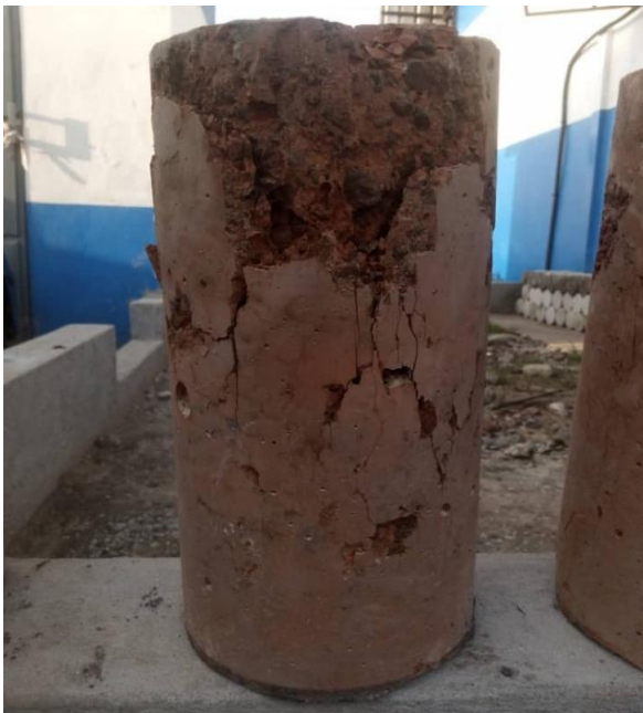
Eprouvette de béton de latérite brute dosé 400kg/m 3 après essai de compression
