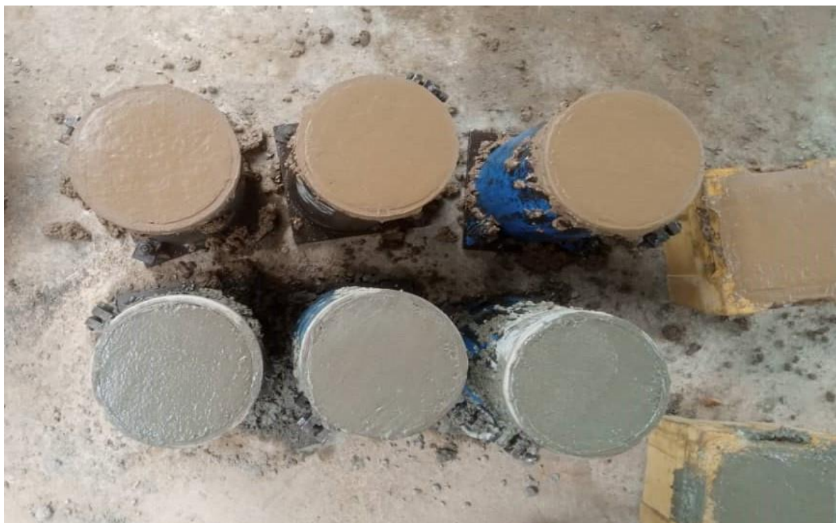
Eprouvettes de béton frais de latérite
