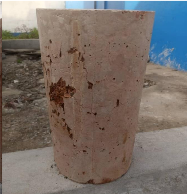
Eprouvette de béton de latérite brute dosé 450kg/m 3 après essai de compression
