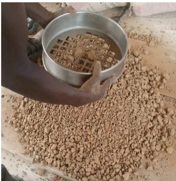
Processus de tamisage pour la séparation des classes de granulats 0/4 et 4/25
