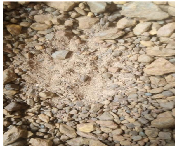
Fig.7 : Aspect d'un échantillon de la latérite après lavage
