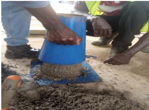
Fig. 19 : Mesures de consistance des mélanges de bétons
