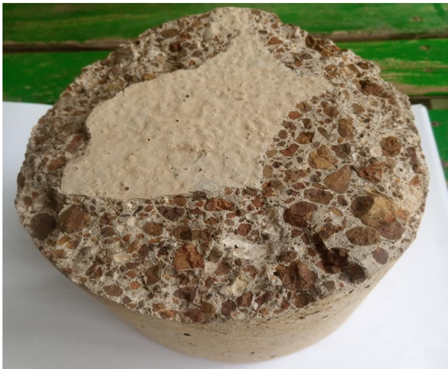
Eprouvette de béton de latérite lavée dose 350\text{kg/m}^3
