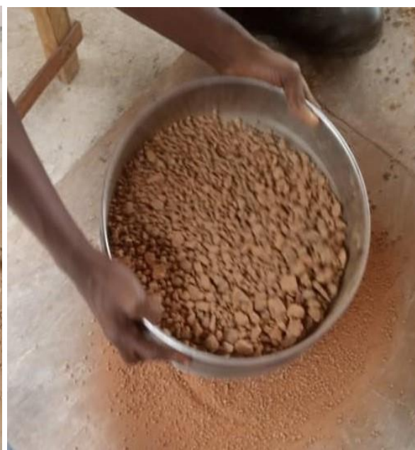
Processus de tamisage pour la séparation des classes de granulats 0/4 et 4/25
