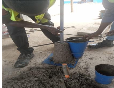
Fig. 19 : Mesures de consistance des mélanges de bétons
