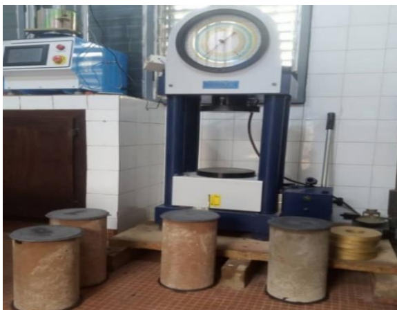
Fig. 19 : Eprouvetttes de bétons durci avant essai de compression
