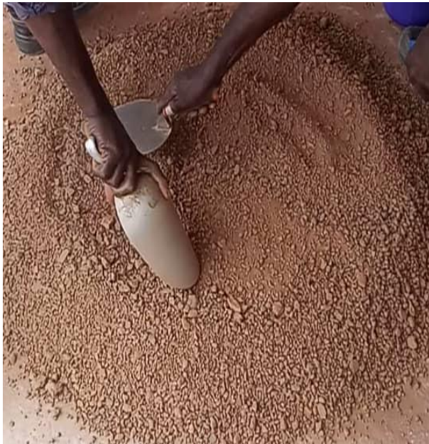
Echantillon de latérite brute pour tamisage
