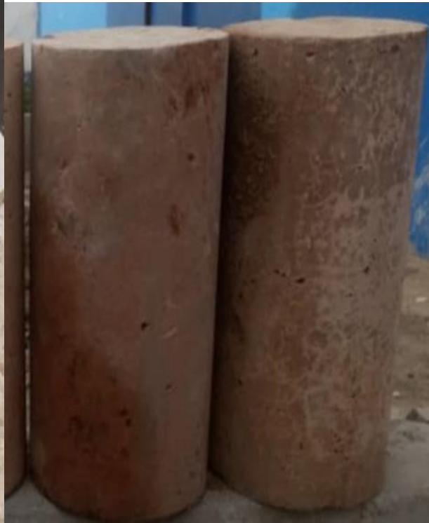
Eprouvettes de béton de latérite brute durci avant écrasement
