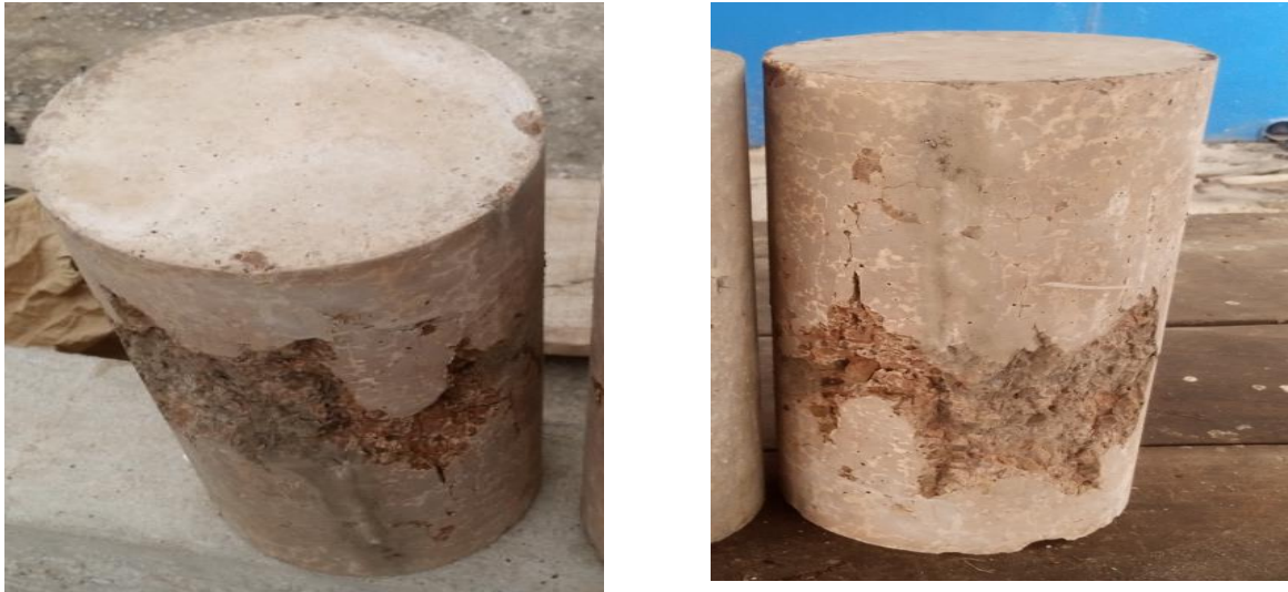
Fig. 21 : Eprouvettes de bétons durci après essai de compression
