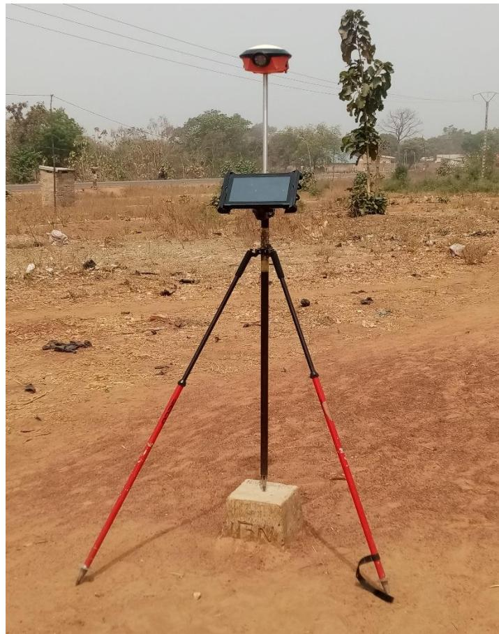
**Photo 3. 3 : Rover du récepteur GNSS-NAVCOM stationné sur la borne IGN04 010, située dans l'Ecole Primaire Publique de SIRAROU pour la calibration.**
