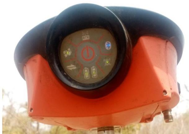
**Photo 3. 2 : Montrant le Rover du récepteur GNSS-NAVCOM allumé**
