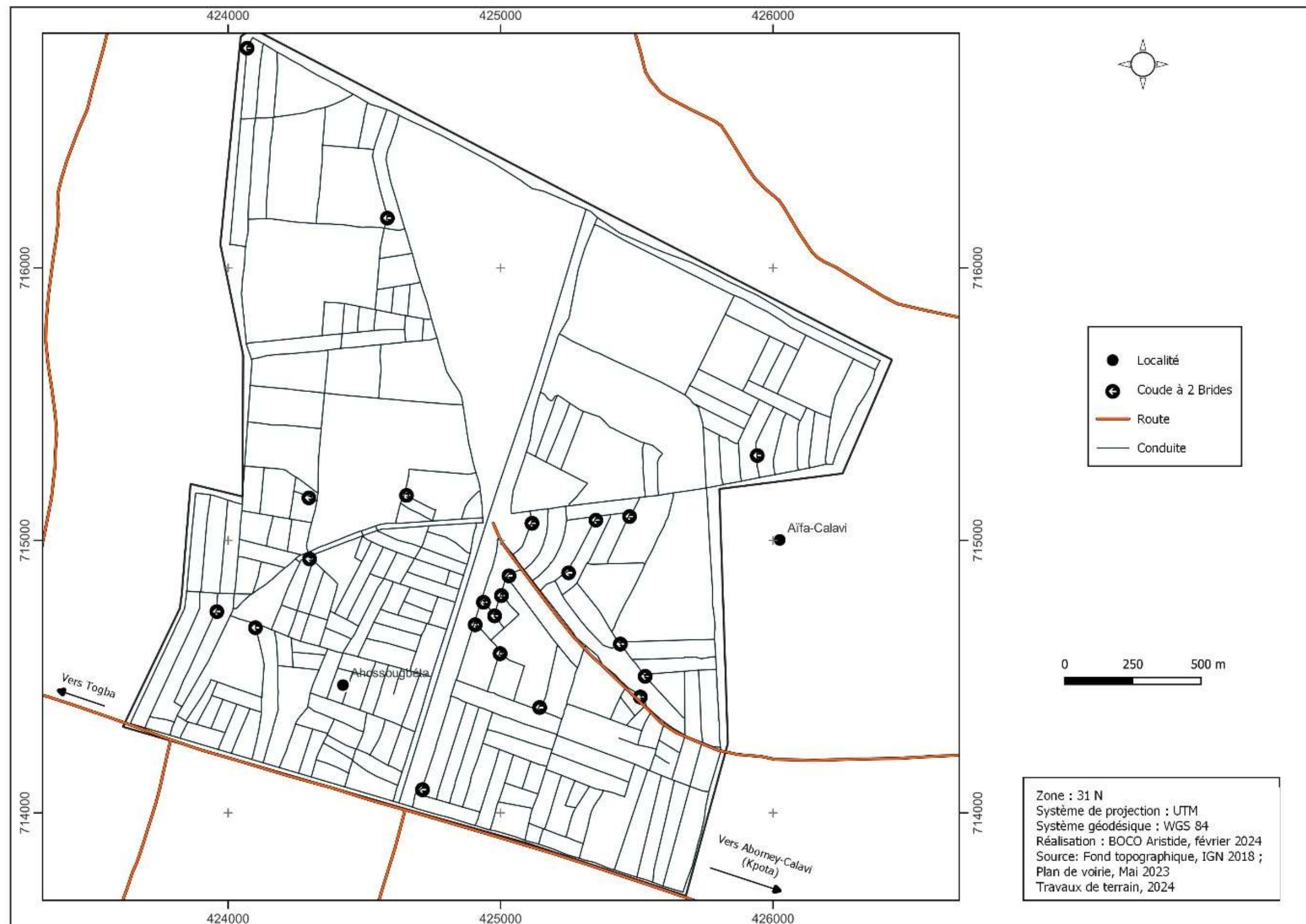
Figure 50 : Répartition des coudes à deux brides dans le réseau AEP de Togba-Est
