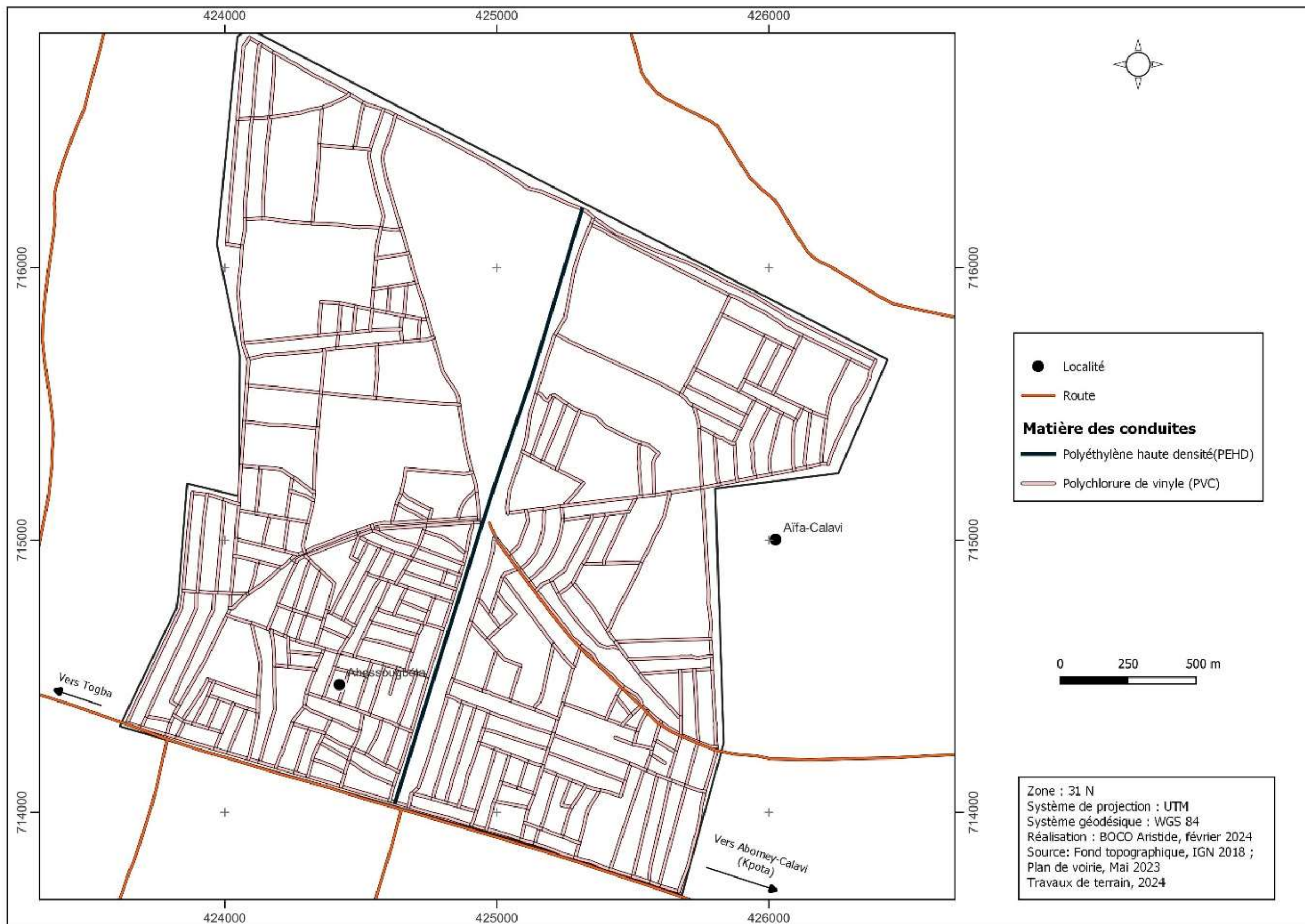
Figure 43 : Types de conduite utilisée dans la réalisation du réseau AEP de Togba-Est
