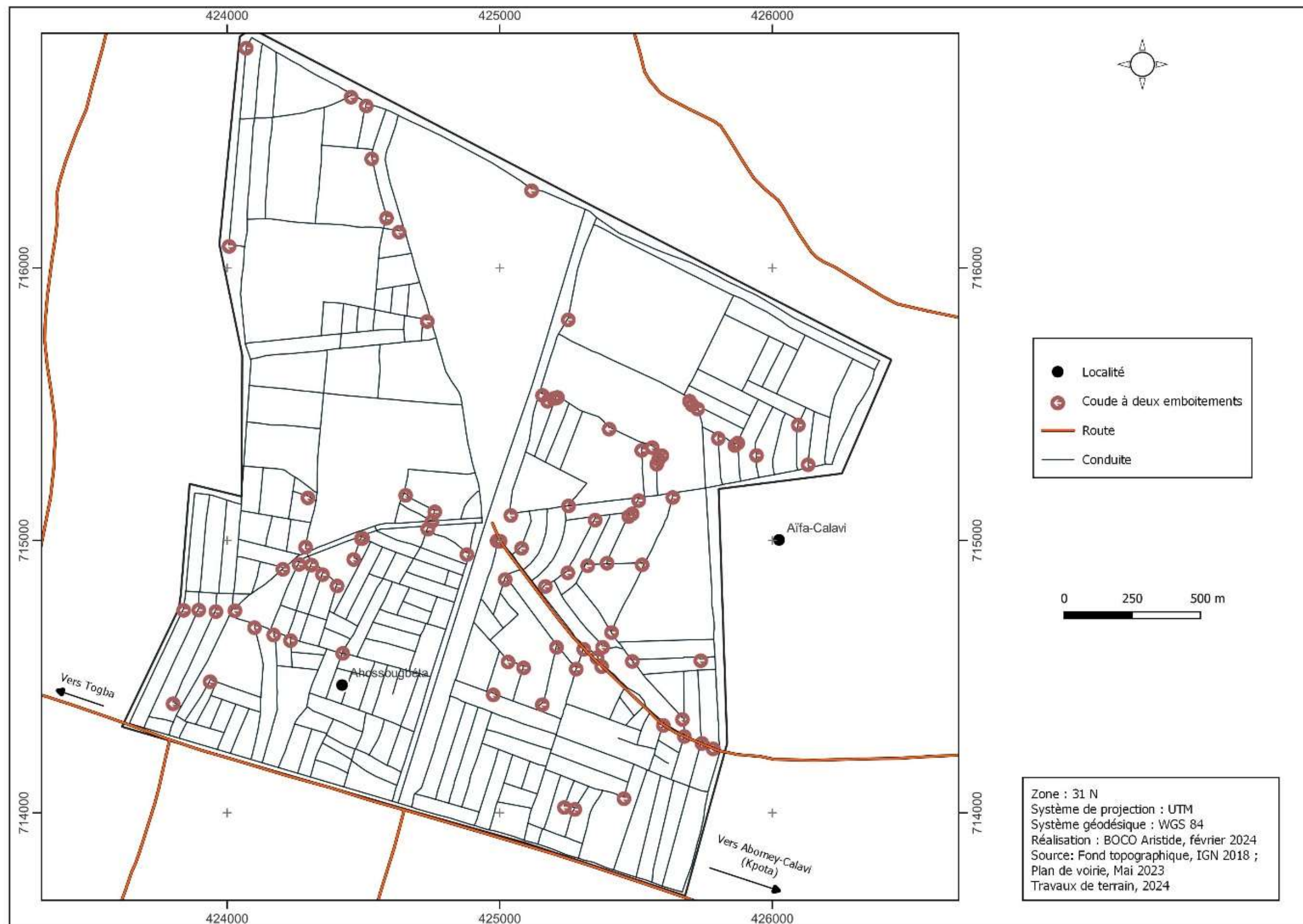
Figure 51 : Répartition des coudes à deux emboitements dans le réseau AEP de Togba-Est
