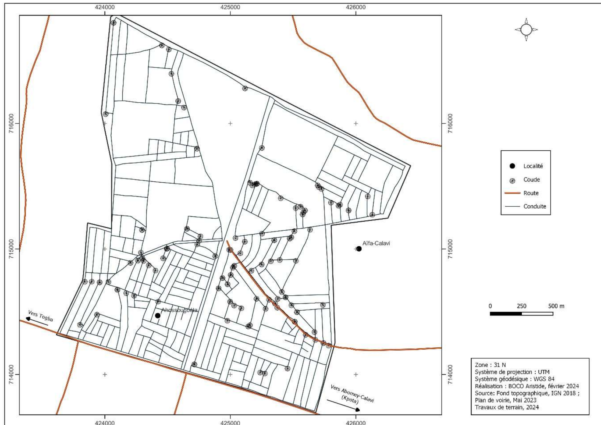
Figure 49 : Répartition des coudes dans le réseau AEP de Togba-Est
