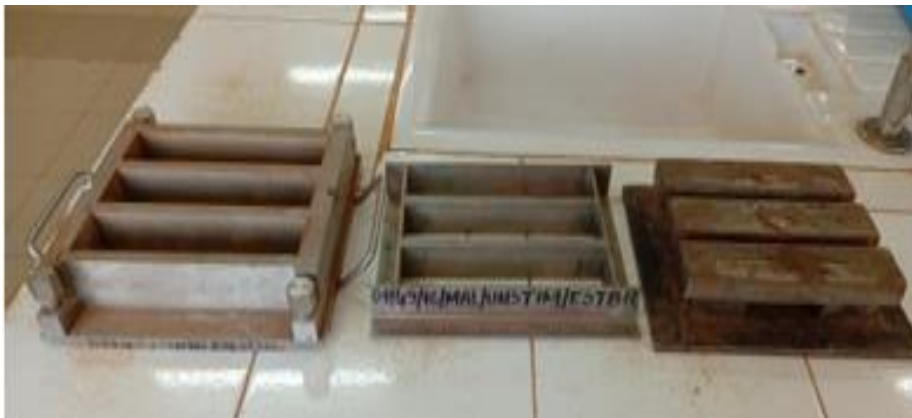
Photo 8 : Moule parallélépipédique, hausse et matériel mâle (A. Servais,2022)
