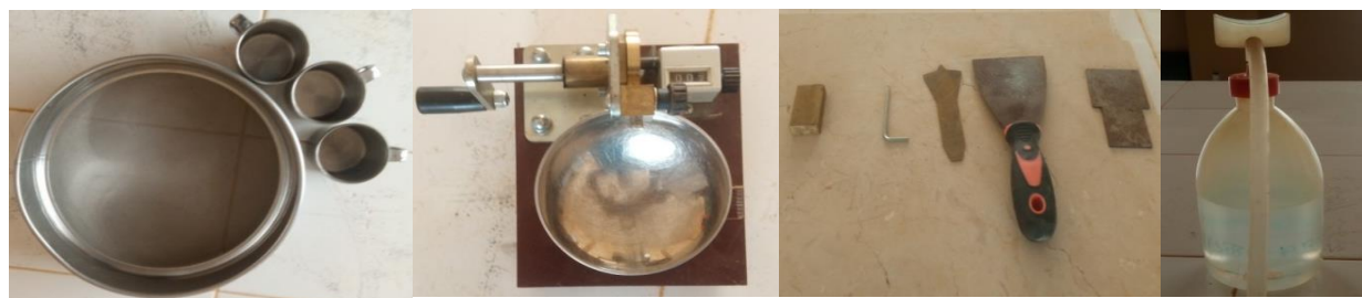
Photo 4: Appareil de Casagrande, tamis d'ouverture 400 \mu et autres outillage d'essai de LA
