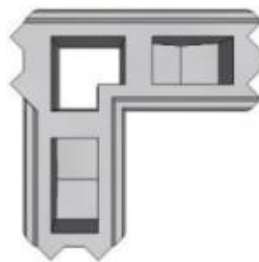
Figure 15: aggloméré d'assise de coffrage vertical en t de 35 cm
