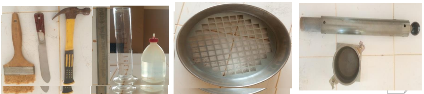
Photo 5: Règle à raser Tamis d'ouverture 20mm et autre outillage d'essai
