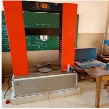
Photo 11: Presse universelle d'essai mécanique
